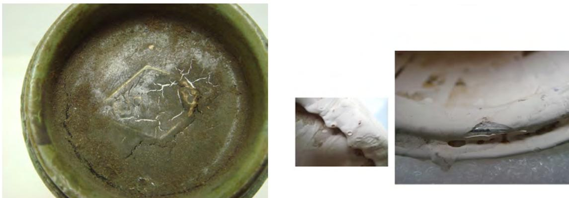
Fig. 3a, b et c : détail de plusieurs types de craquelures trouvés sur des pots de peinture de Ripolin® : (a) craquelures prématurées sur un couvercle (b) bulles ouvertes (c) craquelures au niveau d'une lacune.
