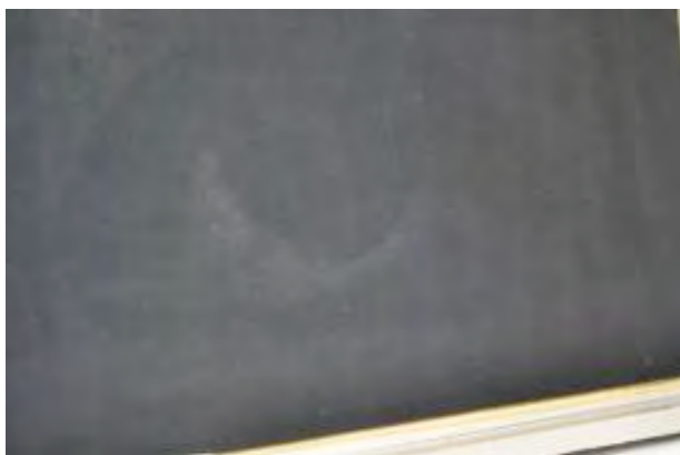
Fig. 79a. Cristal Mirogard® con «imagen fantasma» colocado en el marco a 2 cm de la obra
